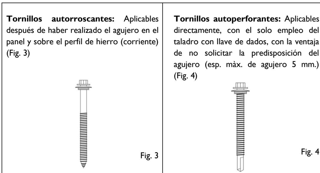
La fijación de los paneles **GLAMET® A42-PI000-G4**, **GLAMET® FRIGO**, **GLAMET® CLEAN**, **GLAMET® Cal. 26/Inox** y **GLAMET® LV** es tipo “a la vista”, con el correspondiente grupo de fijación y la conformación particular de las partes terminales del panel que uniéndose forman un perfecto ensamble con traslape evitando el paso del agua hacia el interior.
