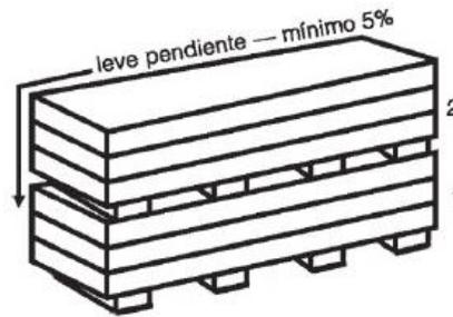
4. Guardar los paquetes bajo techo, si no es posible, proteger con una tela impermeable y asegurarse en todo momento de que hay una adecuada ventilación. La eventual película protectora no debe estar expuesta a los rayos solares y se tiene que desprender en un plazo de 2 meses, desde la fecha de fabricación del panel.
