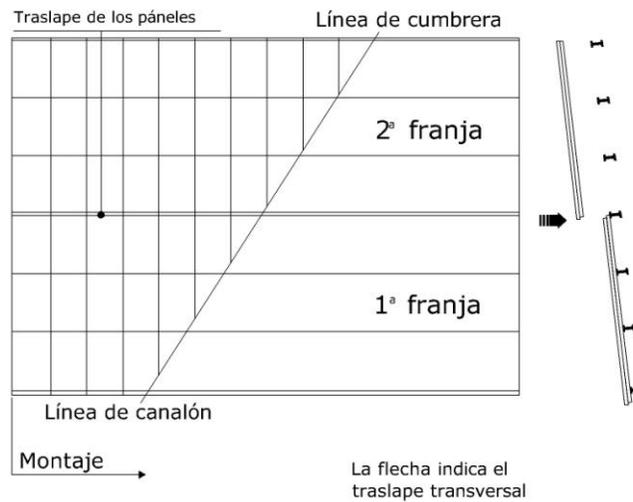
11. Realizar todas las operaciones de los puntos 4.1.1, 4.1.2 y 4.1.3 proceder a la instalación de los paneles iniciando de la primera franja de izquierda hacia derecha, obrando seg n lo indicado en los puntos anteriores 1/8.
