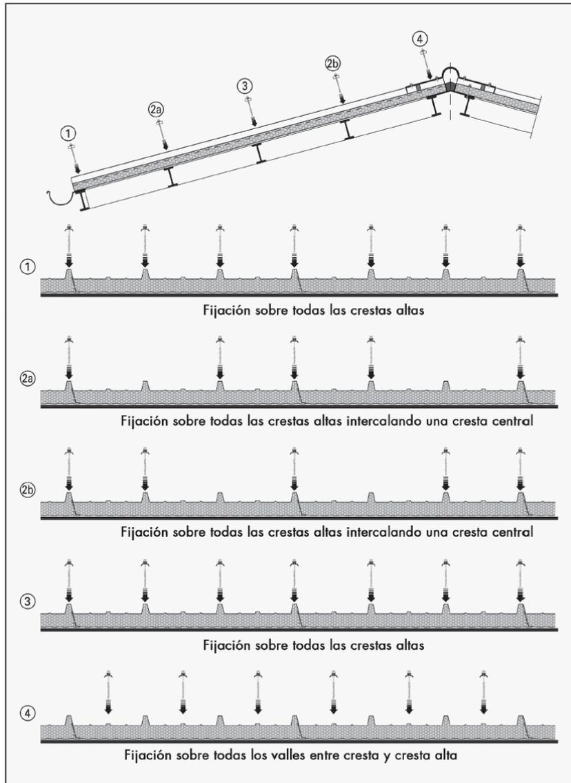
Es común, que para cada proyecto en función de las condiciones locales del viento, de la topografía del terreno y el estudio de las cargas, el proyectista localizará el número de fijaciones a aplicar cuya función es también de reaccionar a las cargas negativas.
