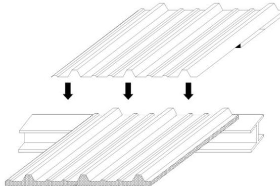
13. La preparación del panel para el traslape transversal se realiza como se marca a continuación:
